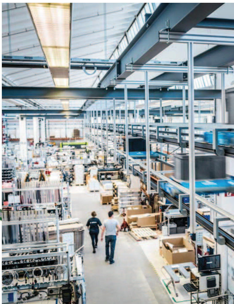
Als Enabler für das Injektionsprinzip fungieren autonome Transportroboter, die platzsparend an der Hallendecke entlang geführt werden. Bild: Servus Intralogistics
