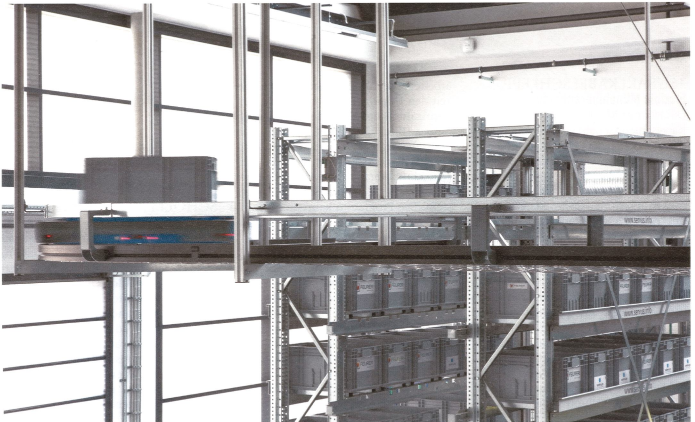
Bild 1 Intelligente Produktionslogistik: Autonome Transporboter mit kleinen Behältern und geringen Inhaltsmengen verwirklichen das Prinzip Fluss.
