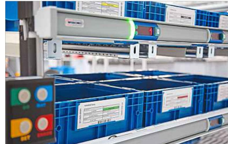
**Simpel, aber effektiv:** Das grüne Licht signalisiert dem Mitarbeiter, in welchen Behälter er greifen muss, um das benötigte Bauteil zu erhalten.
