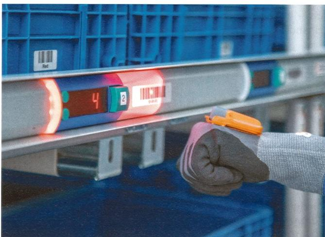
**Bild 2.** „Proglove“ ist ein Arbeitshandschuh mit integriertem Barcode-Scanner.
